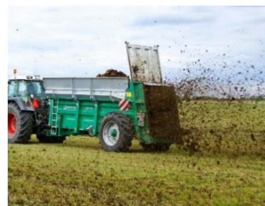
Figure 5 - Epandeur à fumier (crédit : www.ufarevue.ch)
