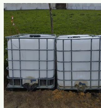
Figure 5 - Cuve IBC de stockage (crédit : Civam blé)
