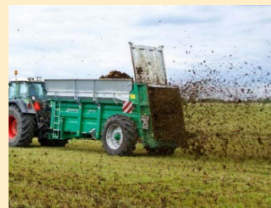
Figure 7 - Epandeur à fumier (crédit : www.ufarevue.ch )
