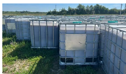
Figure 2 - Cuves de stockage IBC de 1 000 L pleines Toilettes & Co
