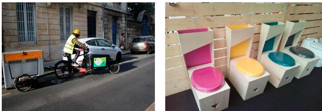
Figure 18 : Tricycle de collecte des excréments (urines et fèces séparées) et toilettes sèches séparatives mises en place dans le cadre de l'expérimentation de l'association La Fumainerie à Bordeaux
