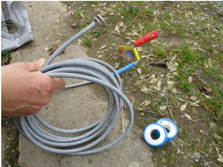
Figure 20 : Furet métallique souple et rouleaux de téflon.
