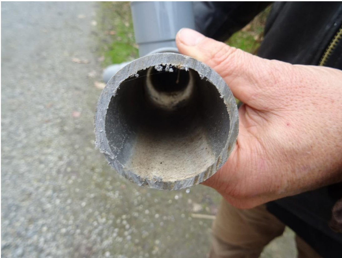
Figure 11 : Réseau après 12 ans de fonctionnement sans ajout d'intrant autre que de l'urine.
