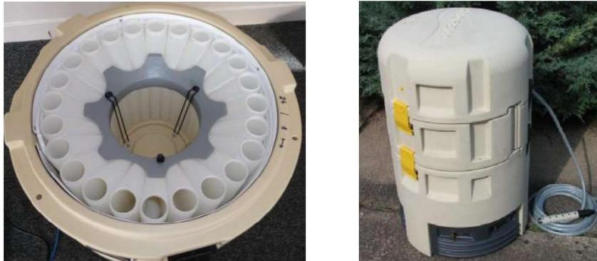
Figure 3 : Prélèvement réfrigéré 24 flacons
