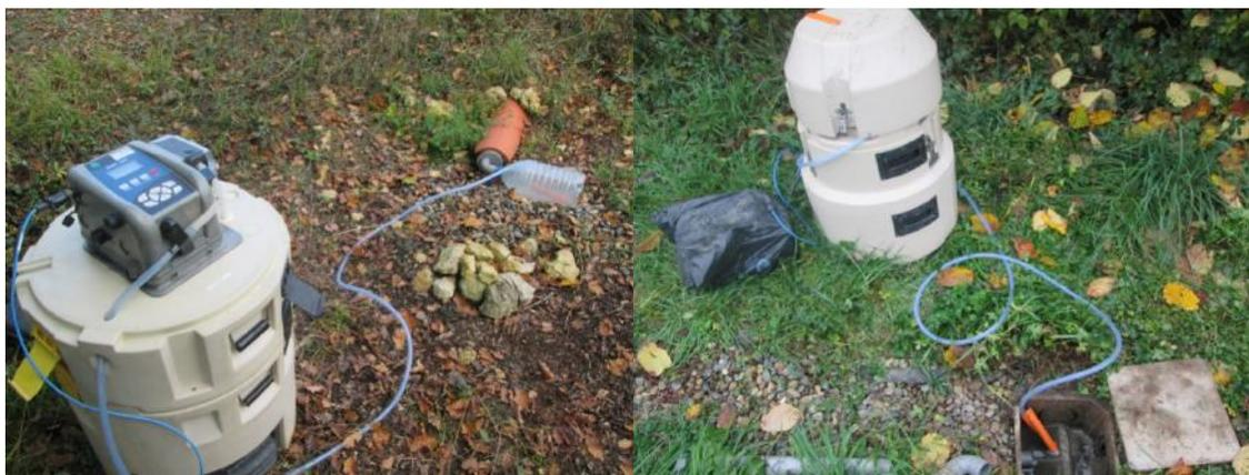
Figure 1 : Préleveur 24 flacons (avec bouteille de prélèvement) et monoflacon (avec seuil)
