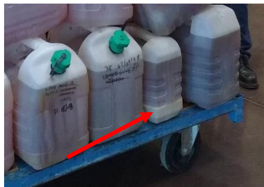
Figure 8 : Précipité visqueux collecté dans la cuve de stockage des urines, projet Azuris (crédit : T. Martin).
